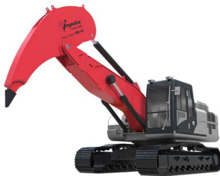
Мегарыхлители для экскаваторов Impulse Ripper-Boom применяются для рыхления мерзлых грунтов, скальных пород мягкой и средней крепости, когда требуется убрать вскрышу (пустую породу) большой мощности (толщины).
