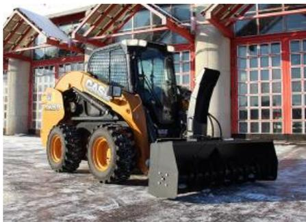
Снегоротор на мини-погрузчики устанавливается на все популярные бренды. Не требует High Flow. Удобен для работы даже в узких пространствах. Регулируемый короб позволяет менять угол и силу выброса снега. Заменяемая кромка из износостойких марок сталей. Максимальная рабочая ширина с максимальной чистотой в очистке улиц и территорий.
