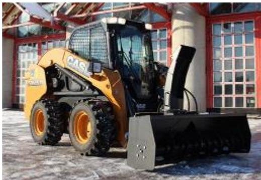
Снегоротор на мини-погрузчики устанавливается на все популярные бренды. Не требует High Flow. Удобен для работы даже в узких пространствах. Регулируемый короб позволяет менять угол и силу выброса снега. Заменяемая кромка из износостойких марок сталей. Максимальная рабочая ширина с максимальной чистотой в очистке улиц и территорий.
