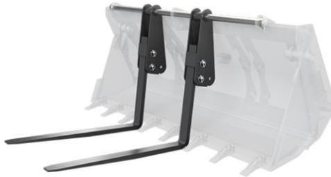
Паллетные вилы откидные Impulse PF2000 – навесное оборудование, которое устанавливается на штатные крепления ковша экскаватора-погрузчика. С их помощью осуществляется перемещение, разгрузка, погрузка насыпных грузов, расположенных на поддонах с грузоподъемностью до 2000 кг.
