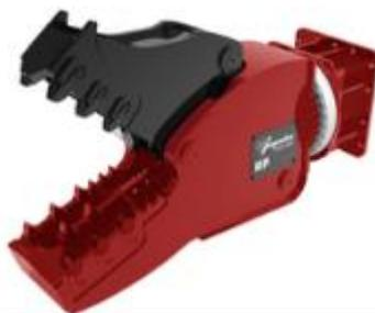
Поворотный гидравлический измельчитель также предназначен для измельчения бетона, отделения его от арматуры и подготовки для дальнейшей переработки в дробильно-сортировочных комплексах для получения вторичного щебня. Ножи в основании челюстей помогают перерезать арматуру. Наличие ОПУ (опорно-поворотное устройство) позволяет также производить демонтаж зданий. Конструкция челюстей оснащена сменными зубьями.
