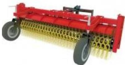
Щетка дорожная задняя Impulse SPB1800 / SPB1800G выпускается в двух модификациях: с механическим и гидравлическим поворотом (G) и предназначена для установки на заднюю навеску тракторов, таких как: Valtra, Fendt, Massey Ferguson, John Deere и другие.
