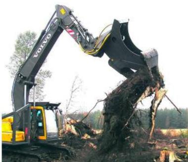
Гидравлический корчеватель по принципу работы похож на гидр노жницы. Применяется он для измельчения и вырывания пней. Оборудование подключается к гидросистеме экскаватора, делая корчеватель мощным инструментом по зачистке территорий. Усилие сжатия напрямую зависит от давления в гидросистеме машины-носителя.
