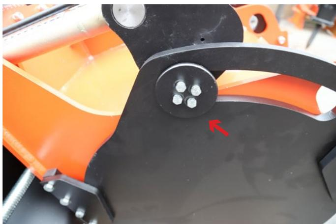
**Примечание:** Эта регулировка необходима при гидравлической установке заглабления в положение «0».
