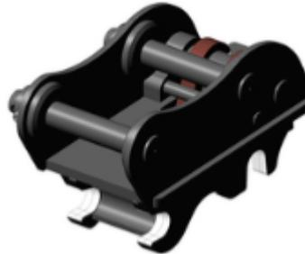
Быстросъем механический Impulse QC предназначен для установки на полноповоротные экскаваторы массой от 19 до 26 тонн. Совместим со всеми видами навесного оборудования. Механизм захвата имеет винтовой тип. Механический винтовой квик-каплер имеет простую конструкцию и среднюю скорость замены (около 5-10 минут) относительно квик-каплеров гидравлического типа. Подойдет тем, кому не требуется частая смена навесного оборудования.
