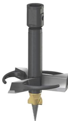
**Измельчитель пней** — рабочий орган гидровращателя, который устанавливается вместо шнека. Он удаляет пни и остатки деревьев, разрушая их до щепы.
