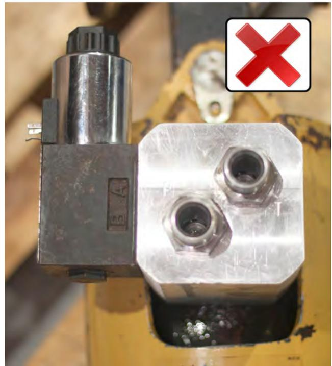
3. Соединить разъем кабеля «2» с розеткой электромагнита распределителя, сняв транспортировочную заглушку.
